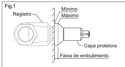
1. Ajuste o corpo do **misturador** na parede.
